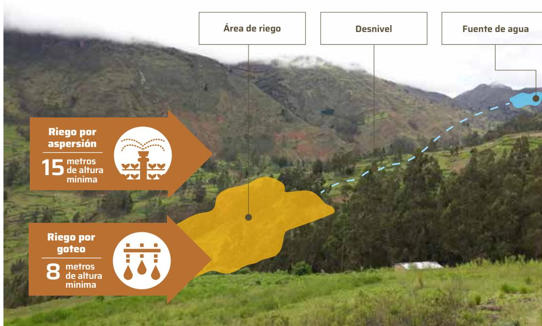
**Nota:** El metro de columna de agua es una unidad de presión que equivale a la presión ejercida por una columna de agua de un metro de altura. Su símbolo es m.c.a. o mca.
